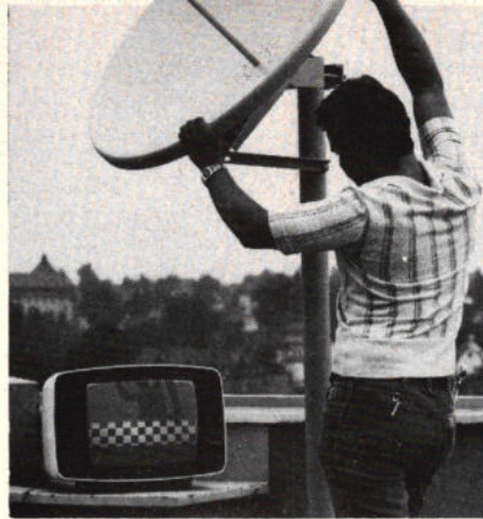
Afb. 20. De parabolantenne met een diameter van 90 cm kan met een eenvoudig mechaniek op de gewenste satellietpositie worden gericht.
