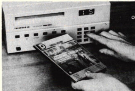
Afb. 14. Het mini-plaatje wordt met hoes en al in de afspeler geschoven. Tijdens het afspelen kan op elk willekeurig moment een bepaald stuk worden opgezocht.
