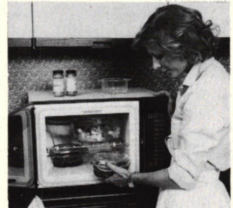
Afb. 18. De microgolfoven Micromat kan worden bediend met behulp van tiptoetsen. De temperatuur is instelbaar tussen 35 en 90 °C.
