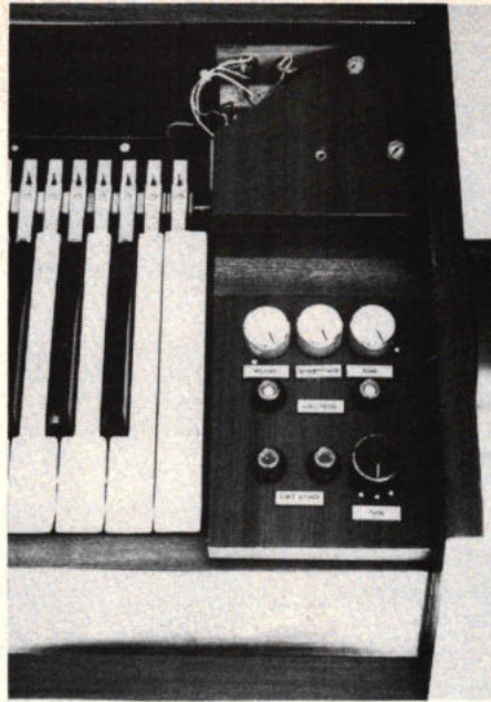
Afb. 6. Op het rechter zijblad zijn 3 potmeters aangebracht, 4 aan-uitschakelaars en een keuzeschakelaar voor de verstemming van de piano. Ook hier bestaan de opschriften uit gegraveerde plaatjes.
