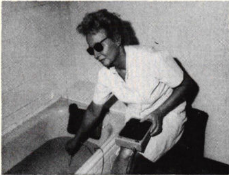
Afb. 12. Ook bedoeld voor visueel gehandicapten is deze sprekende thermometer. Het apparaat is te gebruiken als koortsthermometer, maar ook als kamerthermometer. Het meetgebied loopt van 0...60 °C.
